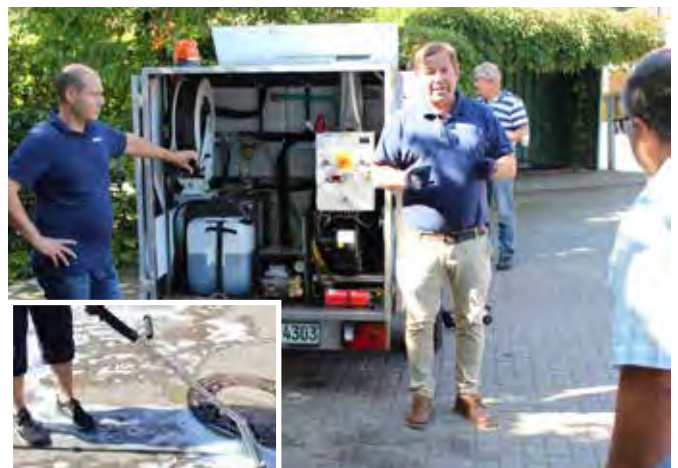
Björn Ziegler (Mitte, ELMO-GmbH) führte ein Gerät zur thermischen Unkrautbekämpfung vor.
